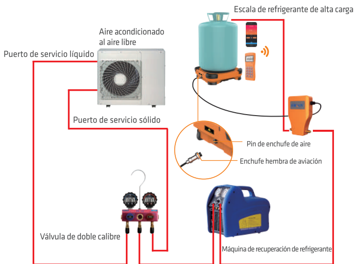
Diagrama de recuperación de refrigerante
