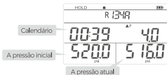
Figura 5 A interface de iniciar o teste de retenção de pressão
