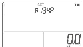
Figura 8 Interface de configuração da unidade de pressão
