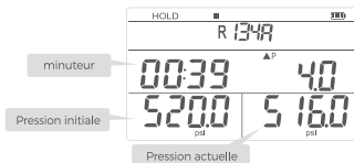
Image 5 Entrer dans l'interface du test pour maintenir la pression
