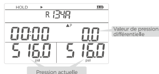
Image 6 Sortir de l'interface du test pour maintenir la pression
