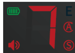
Pantalla en estado de alarma
